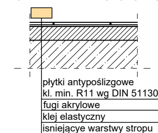
POSADZKI KLATKI SCHODOWEJ
