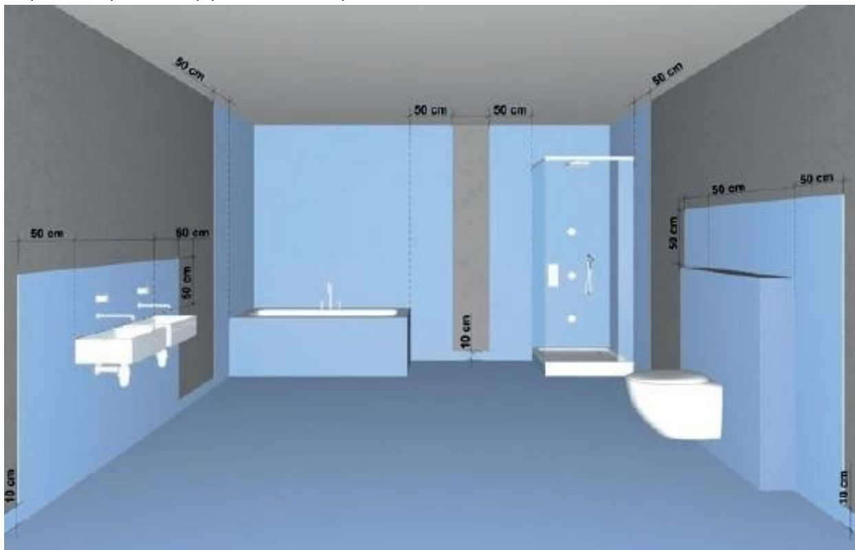
Rys. 1 Strefy wykonania hydroizolacji
