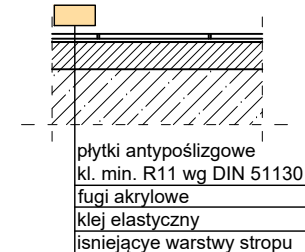
POSADZKI KLATKI SCHODOWEJ
