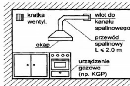
Rys. 173-3. Odprowadzenie spalin z kuchni lub kuchenek gazowych poprzez okap i wentylację pomieszczenia
